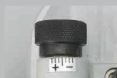
1. Índice copiator con regulación micrométrica
