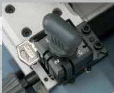
2. Ajuste centesimal por teclado
