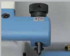
2. Índice copiador con regulación micrométrica
